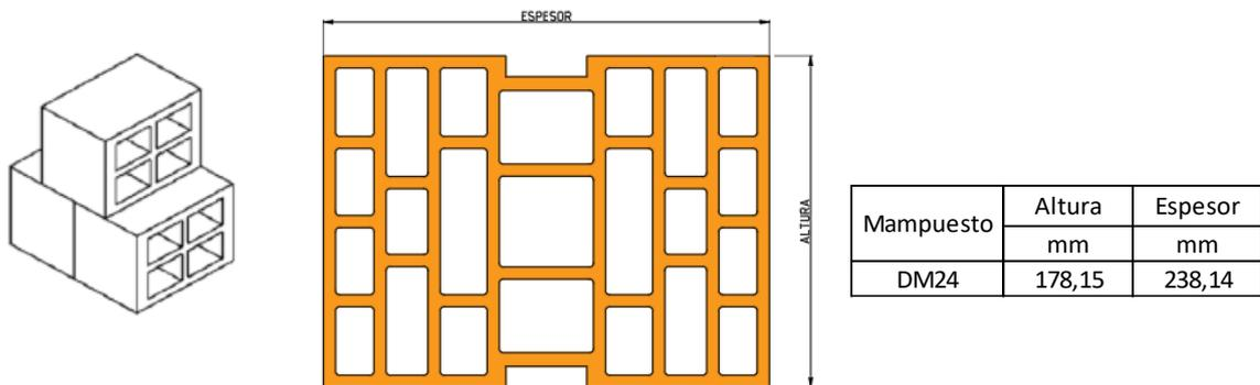
A continuación, se puede observar el modelo de cálculo. Este modelo es un elemento que permite reproducir el muro con la mera repetición del mismo. Tal como indica la Norma UNE mencionada, esto se consigue dibujando el encaje de dos piezas y posteriormente efectuando un corte por dos planos verticales paralelos al flujo de calor. Se debe procurar que los planos de corte dejen a la unión entre bloques en el centro del modelo.
