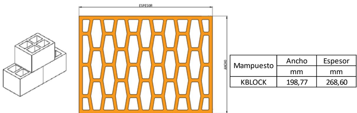
A continuación, se puede observar el modelo de cálculo. Este modelo es un elemento que permite reproducir el muro con la mera repetición del mismo. Tal como indica la Norma UNE mencionada, esto se consigue dibujando el encaje de dos piezas y posteriormente efectuando un corte por dos planos verticales paralelos al flujo de calor. Se debe procurar que los planos de corte dejen a la unión entre bloques en el centro del modelo.
