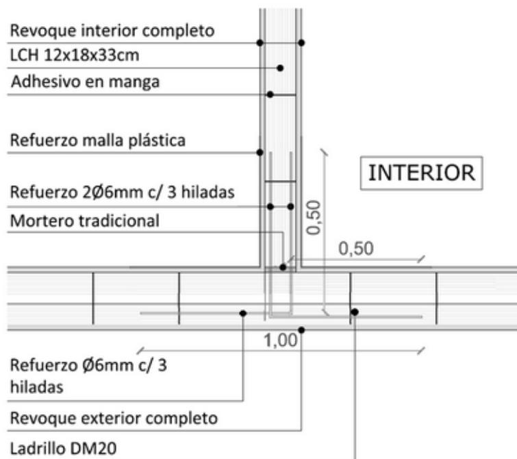
En el caso de utilizar mortero tradicional, los refuerzos se podrán colocar sobre el mismo mortero, pudiendo utilizar ocasionalmente la canaleta central del ladrillo DM20.
