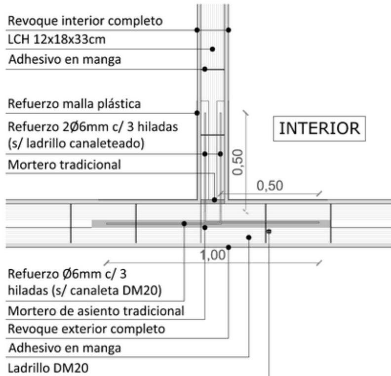
En ambos casos, para reforzar los revoques y evitar la formación de posibles fisuras, en las esquinas interiores se deberá colocar malla plástica.
